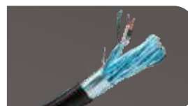
BLFA BIC: Blindagem individual e coletiva em fita de alumínio/poliéster (sobreposição mínima de 25%) com condutor dreno em cobre estanhado, aplicada sobre o conjunto de elementos e também sobre cada elemento (par ou terna), garantindo a transmissão de sinais com baixo nível de ruído.
