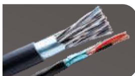
BLFA: Blindagem coletiva em fita de alumínio/poliéster (sobreposição mínima de 25%) com condutor dreno em cobre estanhado, aplicada sobre o conjunto de elementos.
